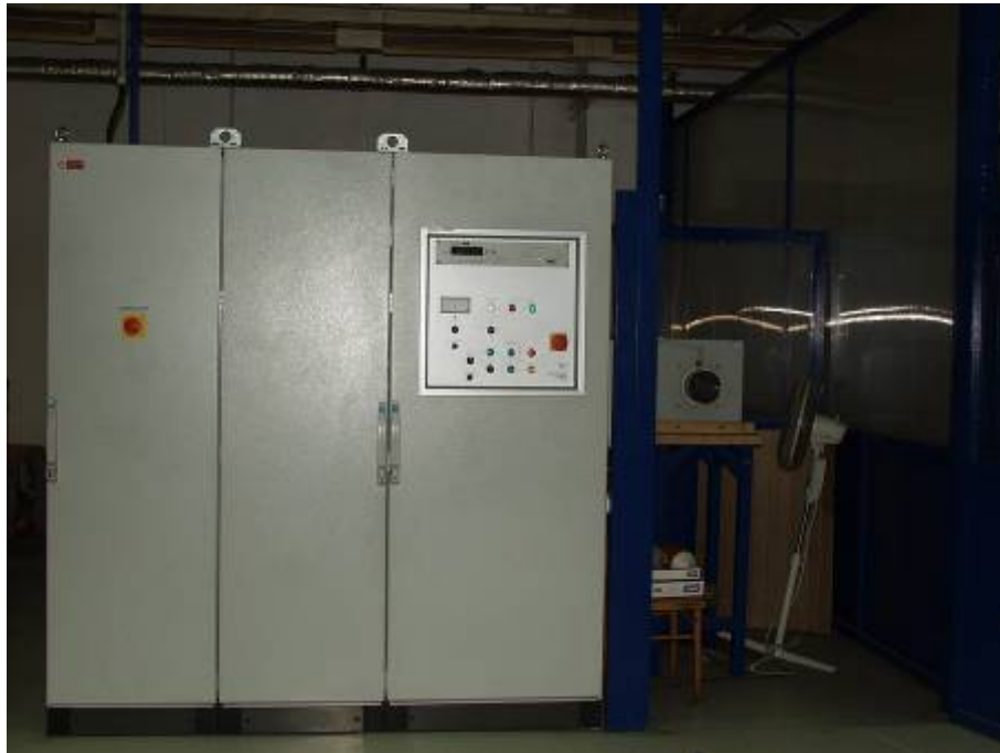
Magnetizační stroj – impuls 14 kA
